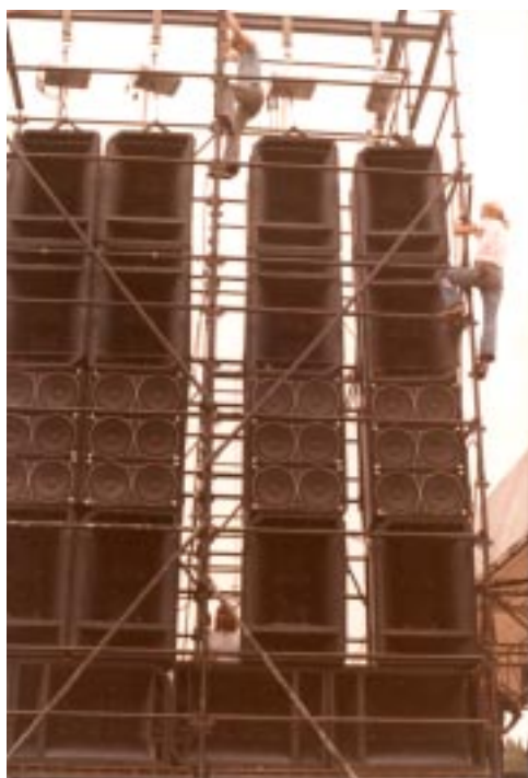
Eagles USA Tour '79におけるNWS Sound System (TAD TL1601a+TD-4001) 2way + TL1601a Super Woofer. 音質、高出力、広帯域、高信頼性全てにわたって画期的な性能を示した。
