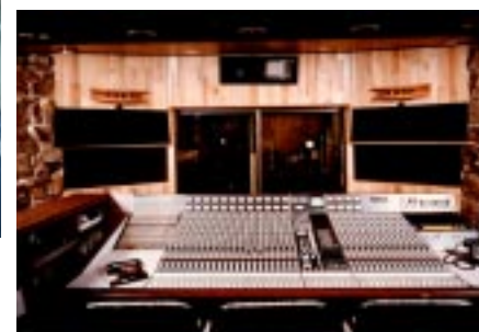
1983年頃のKenDun Studio (CA) Tom Hidleyの設計。モニターはもちろんHidleyMonitor. 3wayの標準構成だったが、TD-4001,TL1601aによって2way化された。
