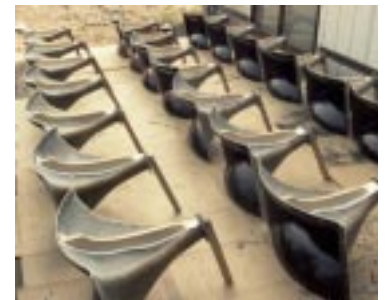
SRに使われるRH-6ホーンの製作風景。FRPをベースにサンドゲンピングを施した強固なホーンである。
